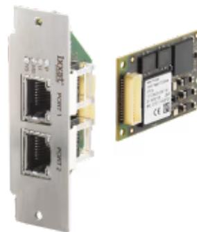
*Ermöglicht die Anbindung von Computersystemen an EtherNet/IP-Netzwerken*
