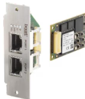
*Ermöglicht die Anbindung von Computersystemen an Powerlink-Netzwerken*
