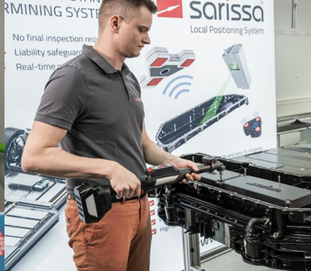
Anbindung des Sarissa Box-PC an die SPS mittels Ixxat INpact (links). Ermittlung der 3D-Position der Hände und handgeführter Werkzeuge mittels Handsender oder Werkzeugmodul (rechts).
