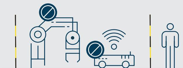
Beim Betrieb von Robotern und AGVs müssen Sicherheitszäune mit sicher verriegelten Türen verwendet werden, damit menschliche Bediener den Betriebsbereich nicht betreten können. Betritt ein Bediener den Gefahrenbereich, müssen alle Bewegungen gestoppt werden. Sobald der Bediener den eingezäunten Bereich verlassen und bestätigt hat, dass dieser sicher und frei ist, erhalten die Roboter und AGVs ein Signal zur Wiederaufnahme des Betriebs.
