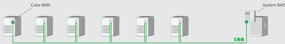
Ausgangssituation: ein langer CAN-Bus ohne Segmentierung
