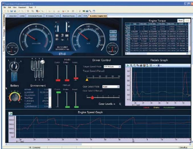
Beispiel eines Test-Dashboards in der LABCAR-Umgebung.
